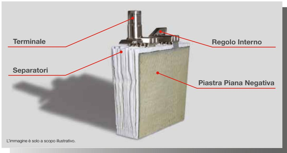
LA GAMMA FGL È COSTRUITA CON TECNOLOGIA AGM (ABSORBED GLASS MAT). L'ELETTROLITA È COMPLETAMENTE ASSORBITO DA UN SEPARATORE IN MICROFIBRA DI VETRO E L'EFFICIENZA DI RICOMBINAZIONE DEI GAS INTERNI È DEL 99%. I MONOBLOCCHI SONO ROBUSTI, ERMETICI E NON RICHIEDONO ALCUN RABBOCCO DURANTE LA VITA DELLA BATTERIA. LA RIDOTTA AUTOSCARICA GARANTISCE FINO A 6 MESI SENZA RICARICA.
