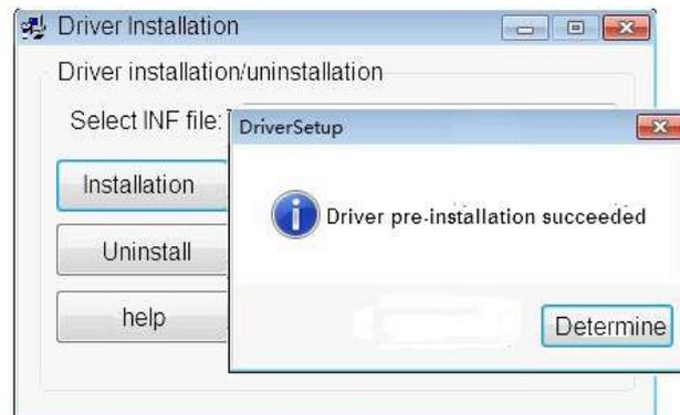
Passaggio 4: Inserire la linea USB del convertitore di comunicazione, quindi accendere il dispositivo di gestione del computer per verificare se è presente un driver di interfaccia USB (USB turn interface driver), il nome del dispositivo del convertitore di comunicazione è CH340, indica che il driver è stato installato correttamente e ricordare il numero di porta seriale corrispondente COMx. Verrà utilizzato in seguito:
